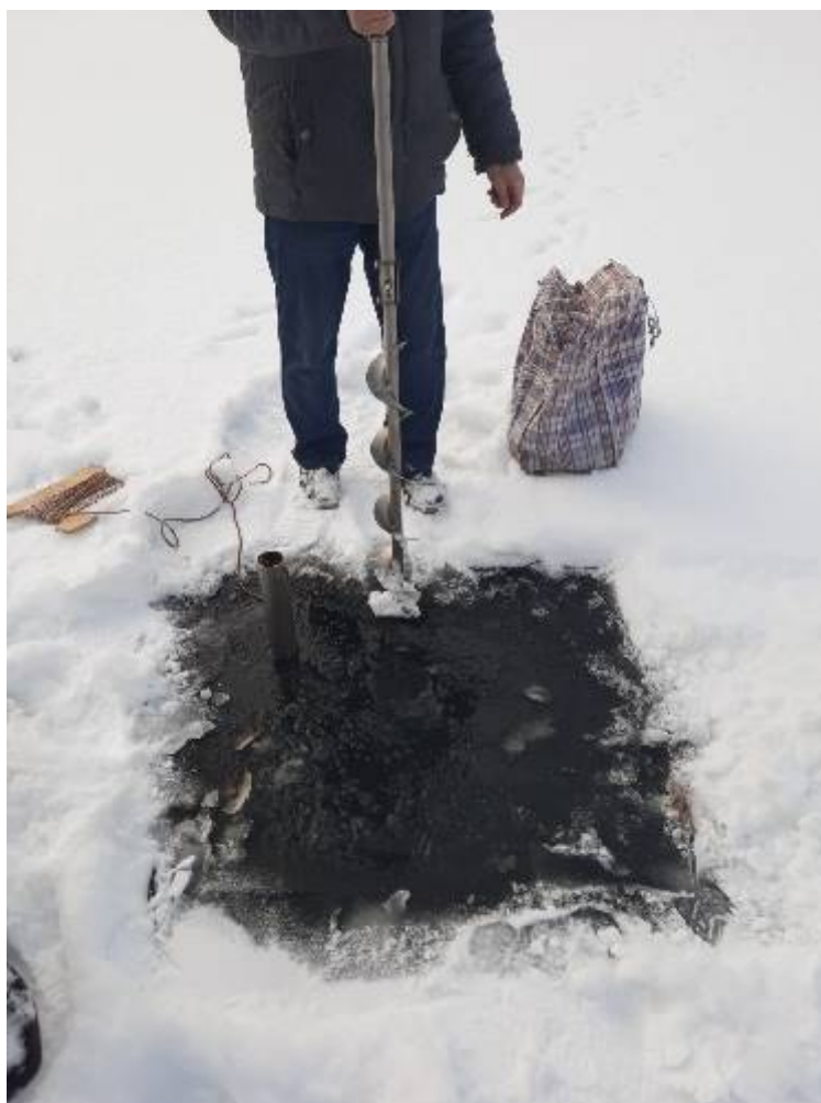
Фото 2.1. Пробуренная лунка на участке исследований в ходе инженерных изысканий
